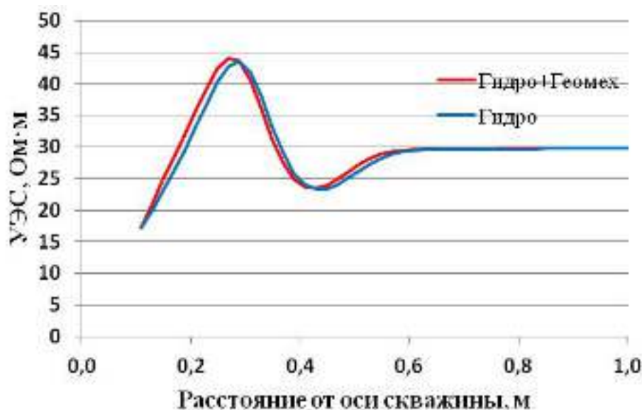
Рисунок 1 Пример подбора синтетических кривых УЭС для образца №1 из таблицы 1. Соответствует 24 часам проникновения фильтра бурового раствора в пласт.
